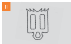
Dichtung für Distanzprofil bei Einsatz XL Sparren Art.-Nr. 191930075
