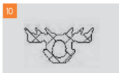
Dichtung für Polycarbonatplatten und Auflage für Poly- und Glaseindeckungen (Sparren + Distanzprofil) Art.-Nr. 191930080
