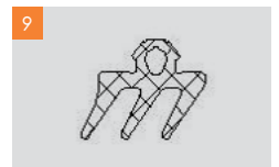
Dichtung für Abdeckprofil bei Glaseindeckung Art.-Nr. 191930051
