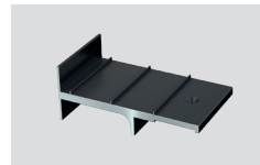
S-Fix Seitliche Fixierung der Platten. Der 5 mm starke Alu-Winkel verhindert die Kippbewegung der Platten bei Kantenbelastung.
