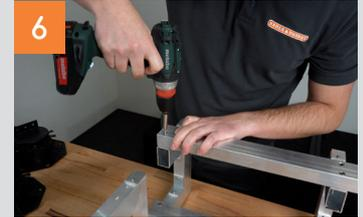
Die zweite Querstrebe auflegen und nach dem gleichen Prinzip mit den Wangen verschrauben.
