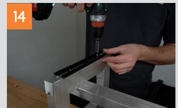
Zugeschnittene Systemleiste mit 2 Bohrschrauben 3,9x16 mm auf die Wange schrauben.
