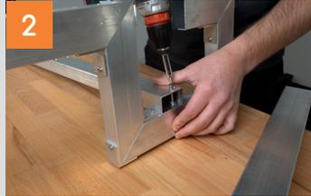
Querstrebe in die Wange einlegen und mit der Senkkopfschraube 4,8x38 mm verschrauben. Dabei die Bohrlöcher mit den Vertiefungen für die Senkköpfe nach oben ausrichten.
