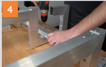
Zweite Wange bis zu den mittleren Bohrlöchern der Querstrebe schieben und mit 2 Senkkopfschrauben fixieren. Dritte Wange einsetzen und ebenfalls verschrauben.
