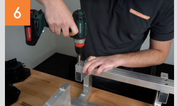
Verschrauben der Treppenwangen mit den Querstreben
