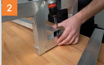
Verschrauben der Treppenwangen mit den Querstreben
