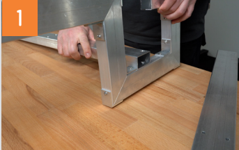
Verschrauben der Treppenwangen mit den Querstreben
