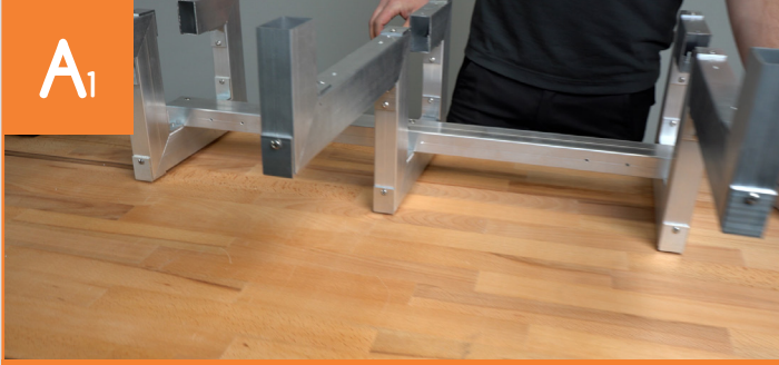
Verschrauben der Treppenwangen mit den Querstreben
