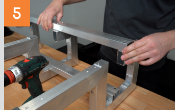
Verschrauben der Treppenwangen mit den Querstreben
