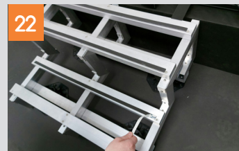
22 Verwenden Sie das mitgelieferte Fixierungsband (10x2mm) und bringen dieses auf alle Querstreben über die gesamte Breite auf.
